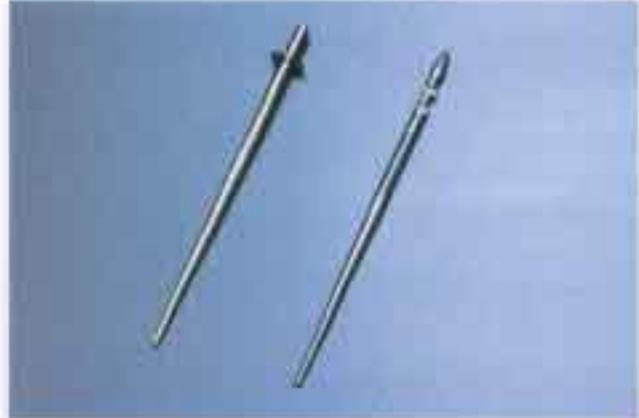
●ジェットニードルのクリップ位置は下から2段目が標準。メンテナンス時、真中(3段目)に組み付けてしまう人が多いので注意したい。左側のニードルは初期のタイプで、クリップを使わずにワンタッチでピストンに取りつけられた。
