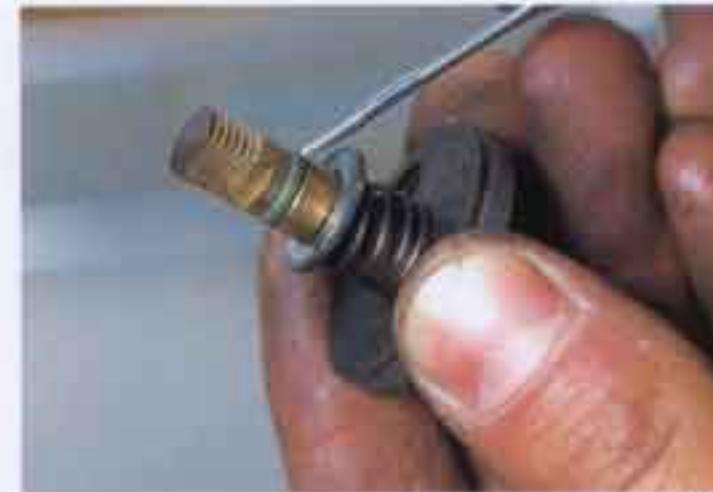
チョークバルブのシャフトにも、エア吸い込みを防止するOリングが付けられている。見落としやすい部分だがここからエアを吸い込んでいることもあるので必ず交換しよう。1個110円だ。
