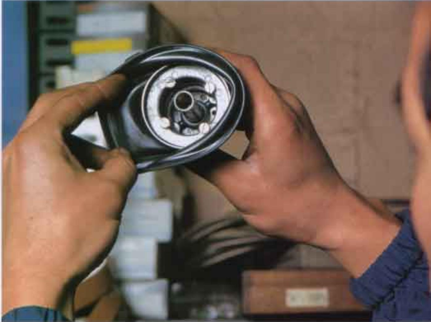
●ダイヤフラムを指で軽く引っ張り。先に透かして破れないかをチェックする。ピンホールのような穴は発見が難しいので念入りに確認したいが、力を入れすぎてダイヤフラムを破ってしまわないように。
