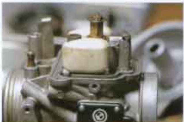
●このキャブの油面調整はとても巧妙で合理的。まず、水平は場所にキャブを逆さまに置く。そしてフロートとキャブボディーが平行であれば油面はOKなのだ。サービスマニュアルにもこのように示されている。(油面調整はフロートのリップを曲げておこなう。
