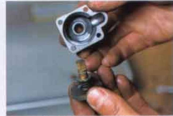
チョークレバーの動きが重い時はプラスドライバーでネジ4本を外して潤滑する。組み付け前に薄くグリスを塗れば出し動きは軽くなるはずだ。ゴムが噛んでキズが付いていないかもチェックしよう。
