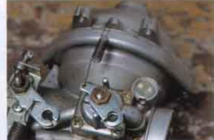
アイドリングが落ちきらないなどロード系でのトラブルは、まずスターターチョークを疑ってみる。スプリングがへたってチョークレバーが完全に戻らなくなっていることがある。新品のスプリングと交換すれば直ることもある。
