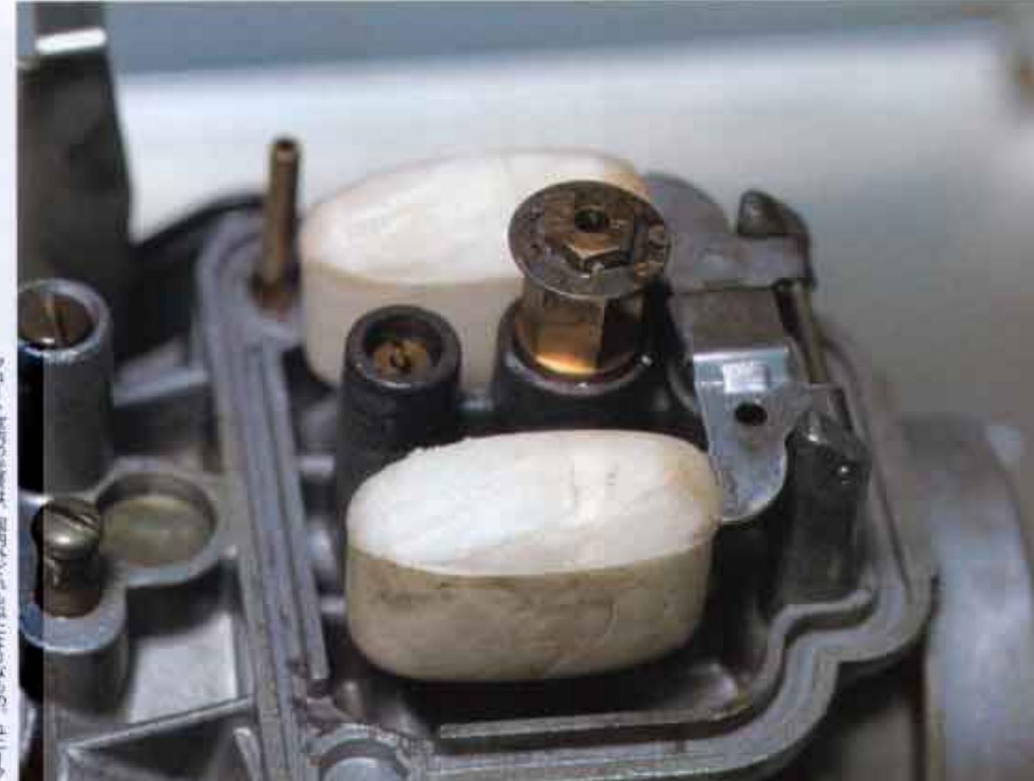
フロート室内の浮子は、国内外どちらも似たようなものの、ユニークなのはメインショットの下に付けられているワッシャー状の構造。ガソリンがフロート室内で沈没づのを防止するらしい。
