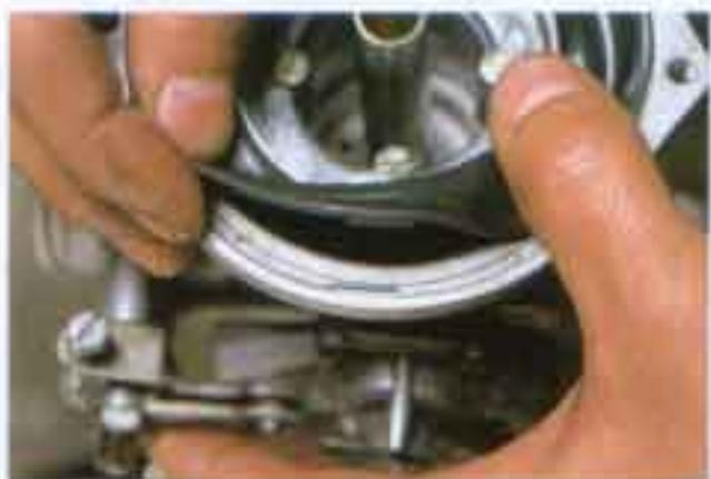
●ピストンとダイヤフラム、ダイヤフラムとボディーにはそれぞれ1カ所ずつ凹凸が付いているので、組み付ける時はそれらを合わせて取りつけよう。CVキャブの仕組みを理解すれば、ここがとても重要なことが判るはずだ。
