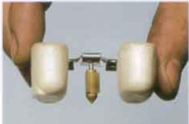
●フロートをバラしたら必ずフロートバルブの先端を点検しよう。ビングのフロートバルブは耐久性が高いのだがキズや陥没を見ついたら要交換だ。フロートにバルブを取りついているクリップは、非常に細いので粗暴に扱わないこと。
